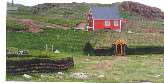
Kuva 2. Qassiarssukiin rakennettu jäljennös viikinkipäällikön talosta, jonka paksut turveseinät eristävät tehokkaasti lämpöä.
